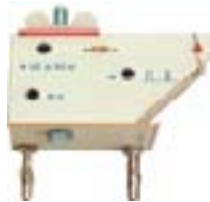
Sortie pour oscilloscope ou chronomètre
