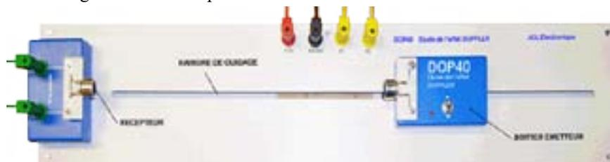
Comprend un générateur Ultra-sonique autonome (alimenté par pile non fournie) équipé d'un transducteur émetteur, un boîtier récepteur avec transducteur récepteur et émetteur supplémentaire, une plaque guide rainurée équipée de 2 barrières lumineuses, un écran avec guides.
