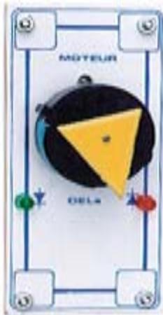
Module 1 : moteur continu (3 à 12V) et 2 DELs. L'axe du moteur est équipé d'un index de couleur permettant de visualiser le sens de rotation ainsi que 2 poulies autorisant des applications en génératrice. Module à enficher sur la plaque d'essais P60.
