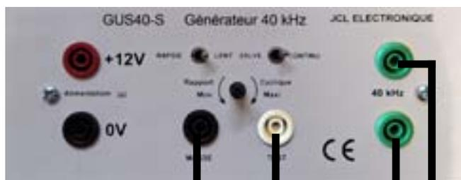
La maquette ECHO40 comprend un générateur ultrasons GUS40-S et un module Emetteur-Récepteur ERUS-S. Les transducteurs émetteur et récepteur du module ERUS-S sont placés dans un même plan vertical.
