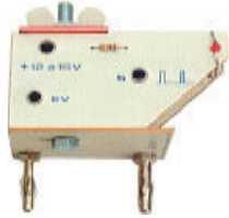
Sortie pour oscilloscope ou chronomètre
